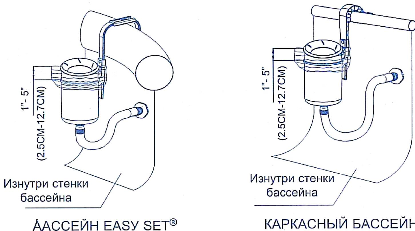
**ВАЖНО:** Скимер всё время должен находиться в вертикальном положении, так чтобы уровень плавучего колпачка был параллелен поверхности воды.
